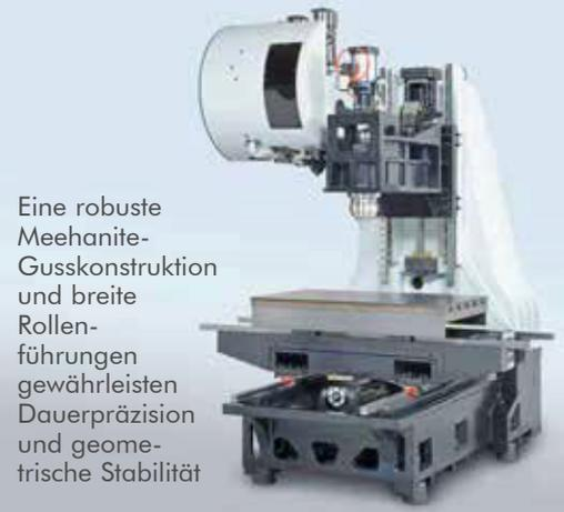
Eine robuste Meehanite-Gusskonstruktion und breite Rollenführungen gewährleisten Dauerpräzision und geometrische Stabilität
