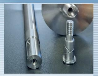
Typische Werkstücke, die auf der LT-300 MYS in einer Aufspannung und mit hoher Präzision gefertigt werden können.
