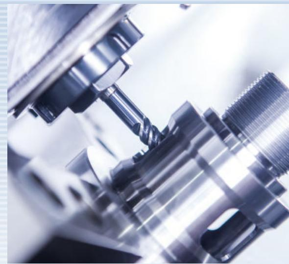
Das Modell LT-15 M+ ist mit angetriebenen Werkzeugen und C-Achse ausgestattet.
