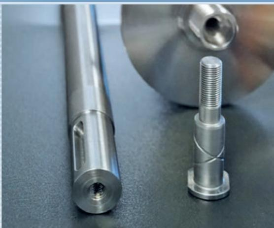
Typische Werkstücke, die auf der LT-300 MYS in einer Aufspannung und mit hoher Präzision gefertigt werden können.
